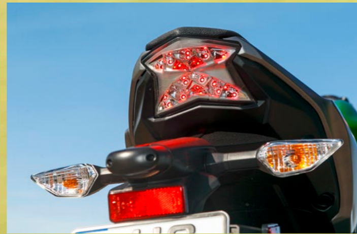
Selbst das voll diodisierte Rücklicht der 650er ist durchgestylt. Daneben sehen die klassisch mit Glühbirnen bestückten Blinker richtig blass aus. Beziehungsweise orange
