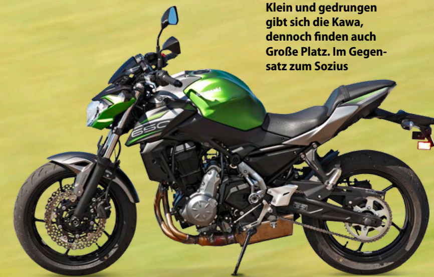
Die lange Bananenschwinge sieht nicht nur supersportlich aus, sie schafft nebenbei auch Platz für den einteiligen Under-Engine-Auspuff im Brotkastenformat
