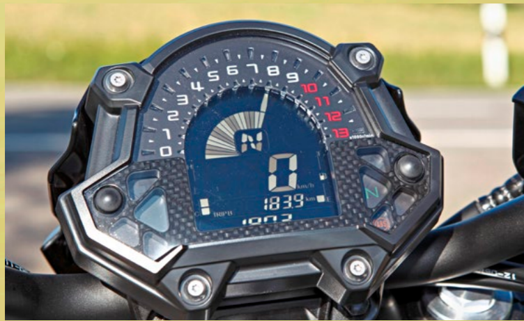
Das Cockpit ist mit dem der Z 900 identisch. Die Balken im Drehzahlmesser zeugen vom Versuch, einen analogen Zeiger digital darzustellen. Das klappt leider nur bedingt
