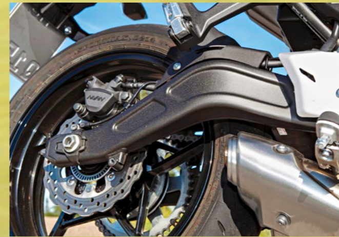
Die lange Bananenschwinge sieht nicht nur supersportlich aus, sie schafft nebenbei auch Platz für den einteiligen Under-Engine-Auspuff im Brotkastenformat
